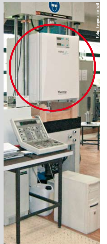
Zugmaschine mit eingebautem Zellkultur-Brutschrank (Kreis) und zugehörigen Steuercomputern. Bis zu 86.000 Belastungszyklen werden damit pro Zugprobe gefahren.
